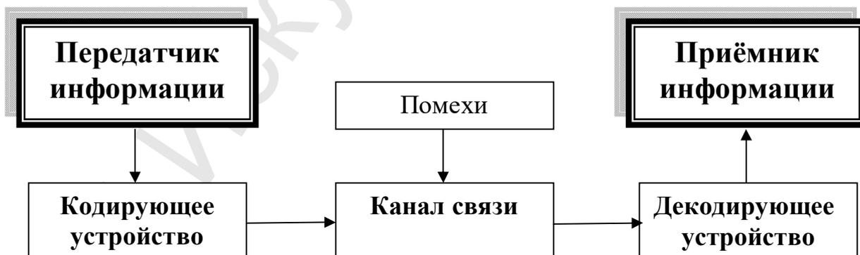
Рисунок I.1.1.A. Схема передачи информации.
