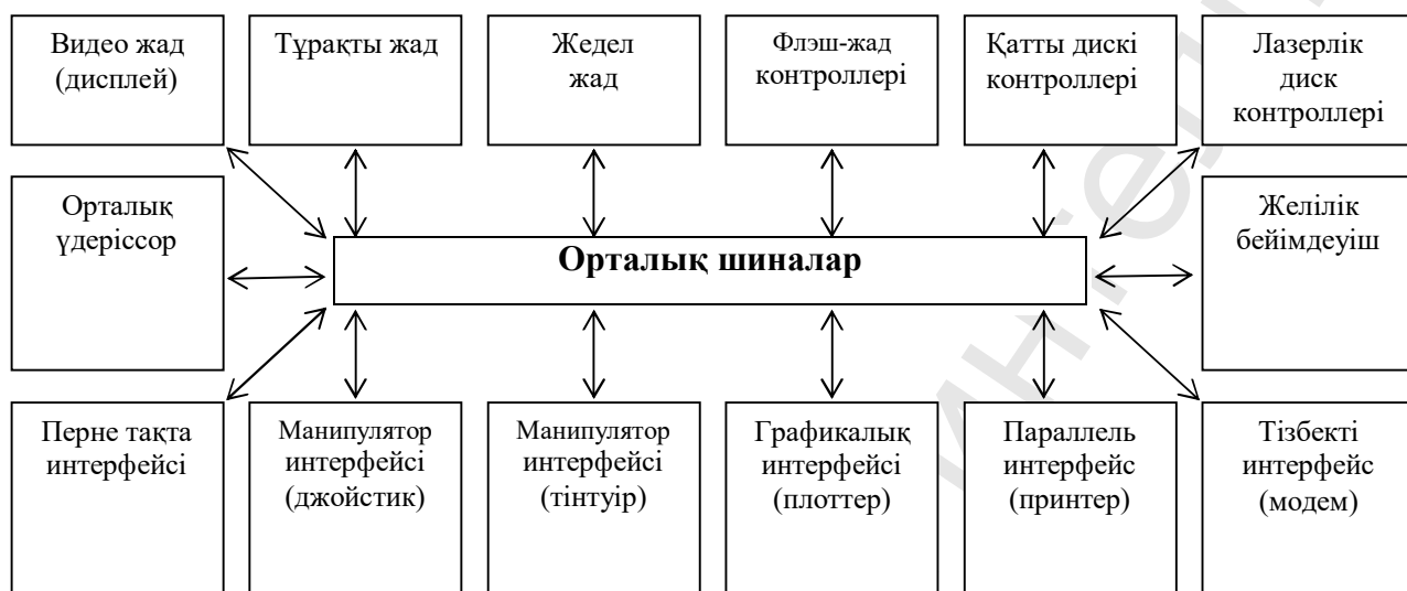
II.1.4. Сурет. Дербес компьютердің құрылымы
